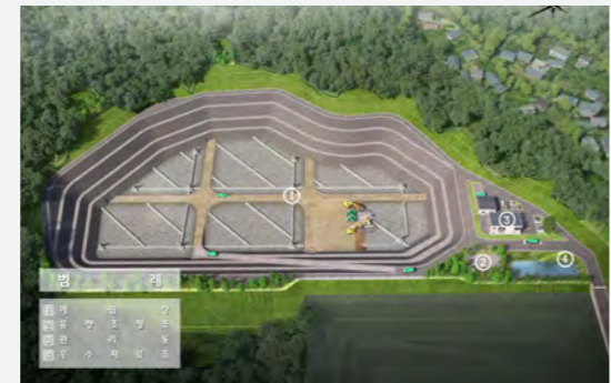
청주시 제2매립장 조성사업 기본 및 실시설계 Preliminary and Detailed Design for the second landfill construction project in Cheongju-city 위치 : 청주시, 사업면적 : 224,354㎡ 매립면적 : 85,090㎡, 매립용량 : 1,965,000㎡ Location : Cheongju city, Site area : 224,354㎡, Landfill area : 85,090㎡ 한국환경공단 Korea Environment Corp.
